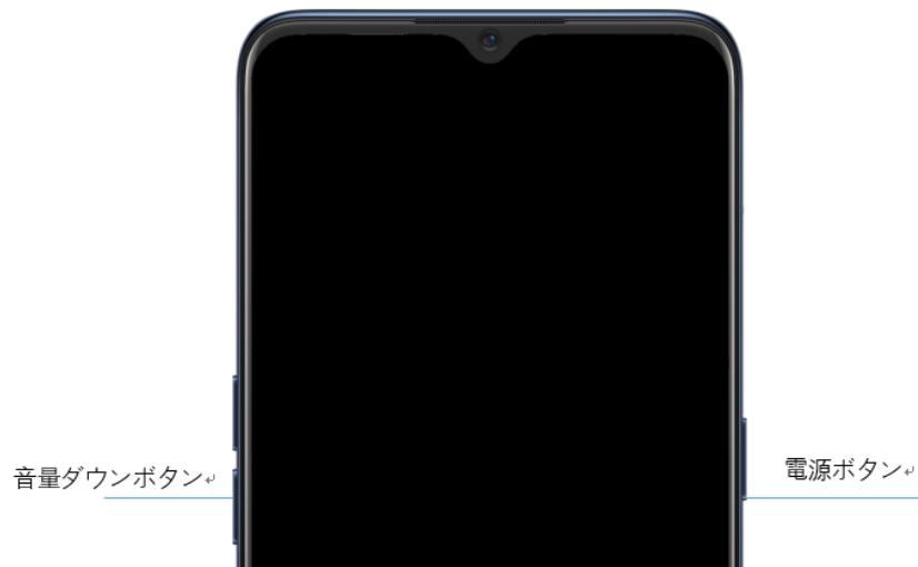
電源ボタンと音量アップボタンを押したままにする：端末が強制的に再起動されます。電源が
