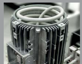
STATOR: FÜGEN IN KÜHLMANTEL / GEHÄUSE
