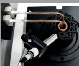
ROTOR: FÜGEN DER WELLE
