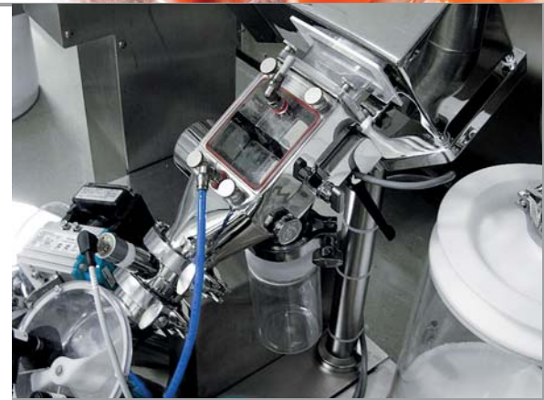
THS/PH21N-WIP: Wash-in-Place Metalldetektionssystem.
