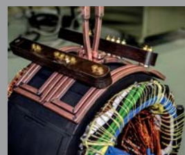
STATOR: IMPRÄGNIEREN / ISOLIEREN
