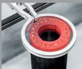
ROTOR: LÖTEN KURZSCHLUSSLÄUFER
