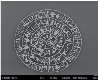
ΕΙΚΟΝΑ 3.9 Ο Δίσκος της Φαιστού, το σύμβολο του ΙΤΕ. Εδώ, χάραξη με ηλεκτρονική δέσμη (εικόνα από το ηλεκτρονικό μικροσκόπιο).
