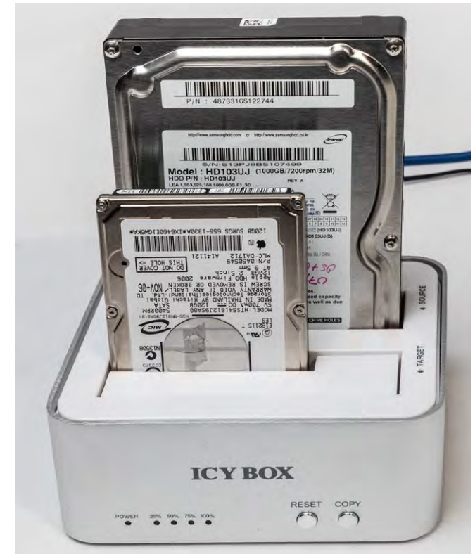
Abb. 2: Eine Harddisk-Docking-Station mit zwei Schächten (beide sowohl für 3,5"- als auch 2,5"-SATA-Laufwerke) erlaubt das autarke Klonen zwischen zwei Harddisk- oder SSD-SATA-Laufwerken. Man kann die beiden Laufwerke aber auch über das Rechner-Interface ansprechen (hier per USB 3.0) und das Sichern oder Klonen mit entsprechender Software vornehmen. Solche Einheiten gibt es von mehreren Firmen.
