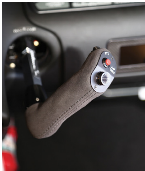
O característico sidestick do Cirrus e abaixo dá para notar como fica o conjunto quadripá em relação à frente e altura da aeronave. No painel a suíte Garmin Perspective +.
