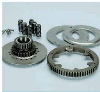
202.0001 Vespa P200E,T5 Z=23/64 Primary ratio-Primario
