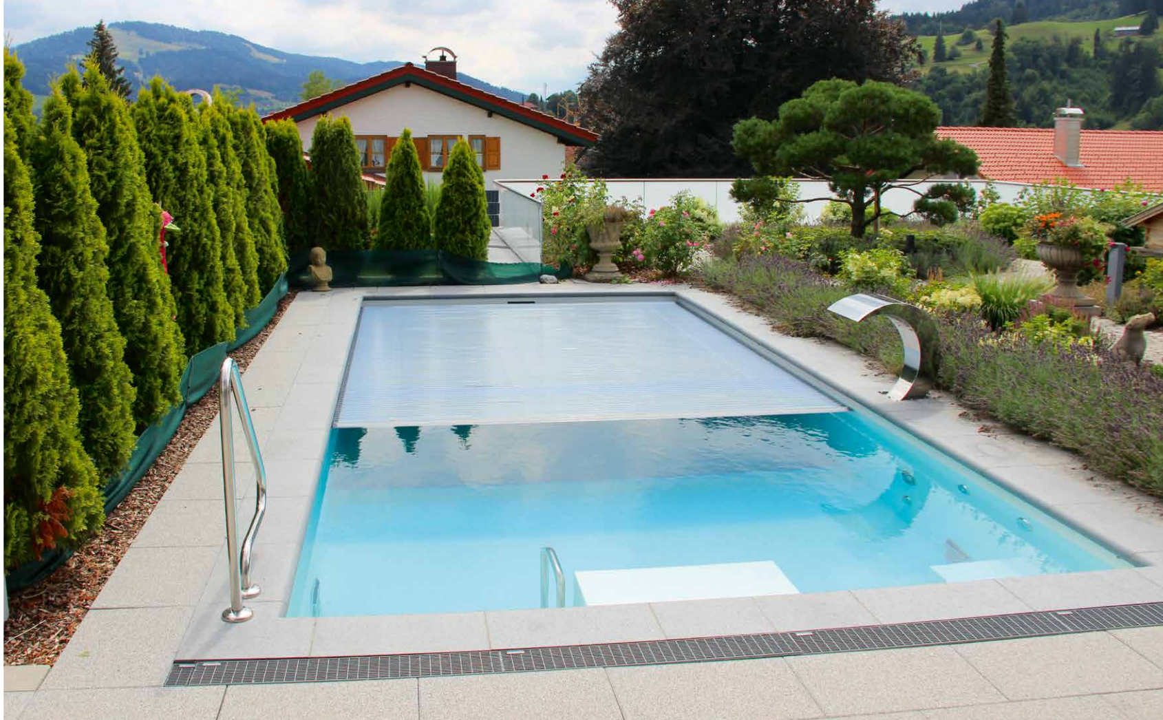
Zur Ausstattung des Beckens gehören auch eine Rollladenabdeckung mit Solar-Lamellen und eine Schwalldusche.
